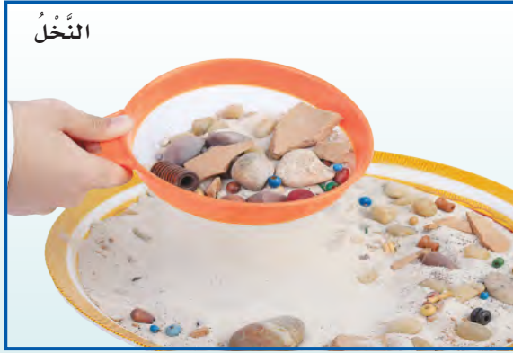
يستخدم المنخل لفصل مواد مختلفة الحجم.
