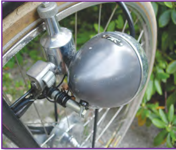
يتصل المولد الكهربائي بعجلة الدراجة
