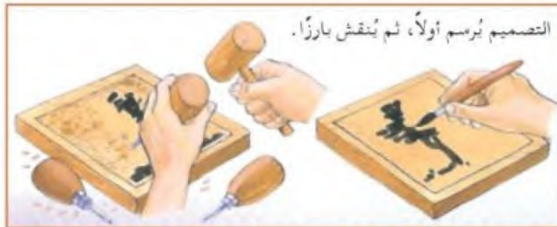
الشكل (١١٧): طريقة تنفيذ الإشارات بالحفر على الخشب.
