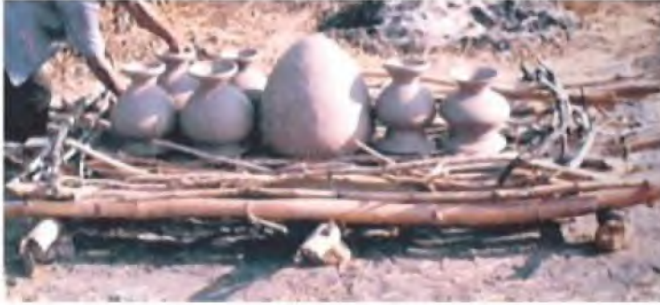
الشكل (٣٨) : الطريقة التقليدية لتجفيف البطانات.
