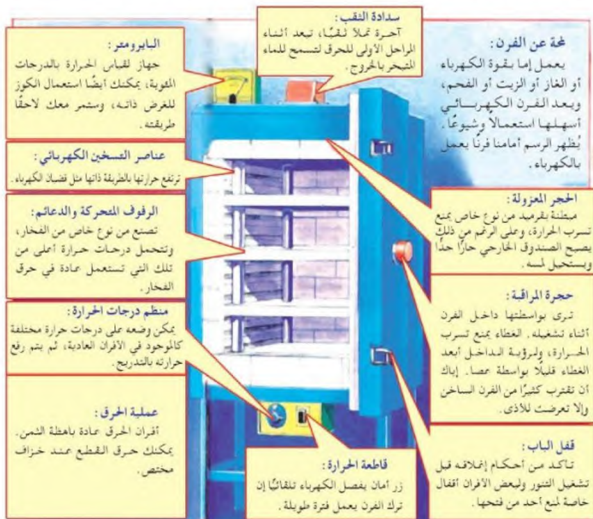
الشكل ( ٥٨ ) : الأفران الحديثة أو الكهربائية والأجزاء التي تتكوّن منها.
