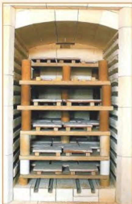
الشكل (٦٠): طريقة رص القطع الطينية في الفرن الكهربائي.
