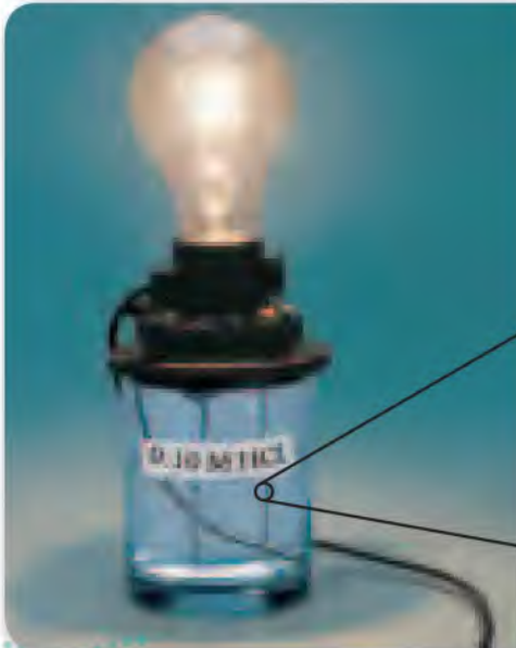
الشكل 2-11 يتوهج المصباح بقوة عندما يوضع القطبان في محلول حمض الهيدروكلوريك بتركيز 0.10\text{ M} ؛ لأن جميع \text{HCl} تتحلل إلى أيونات هيدروجين وأيونات كلوريد.
