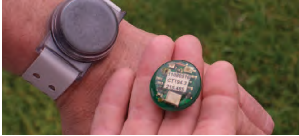
الشكل "12-2" قد تُربط أجهزة استشعار خاصة بساق أو معصم الشخص المصاب بالتوهان.
