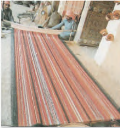
الشكل (٩): نول أرضي لإنتاج قطعة كبيرة.
