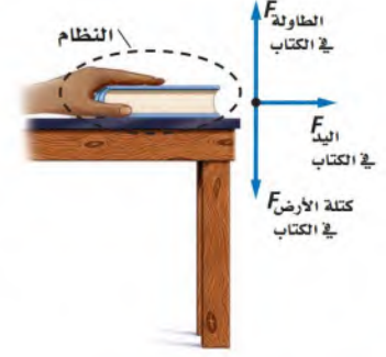
■ الشكل 1-4 يُمثل الكتاب هنا النظام، وتؤثر كل من الطاولة واليد وكتلة الأرض (من خلال الجاذبية الأرضية) بقوى في الكتاب.
