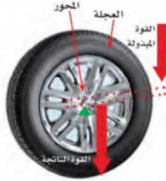
الشكل ١٨ نصف قطر العجلة أكبر من نصف قطر المحور. ولذلك تكون الفائدة الآلية للعجلة والمحور أكبر من واحد.
