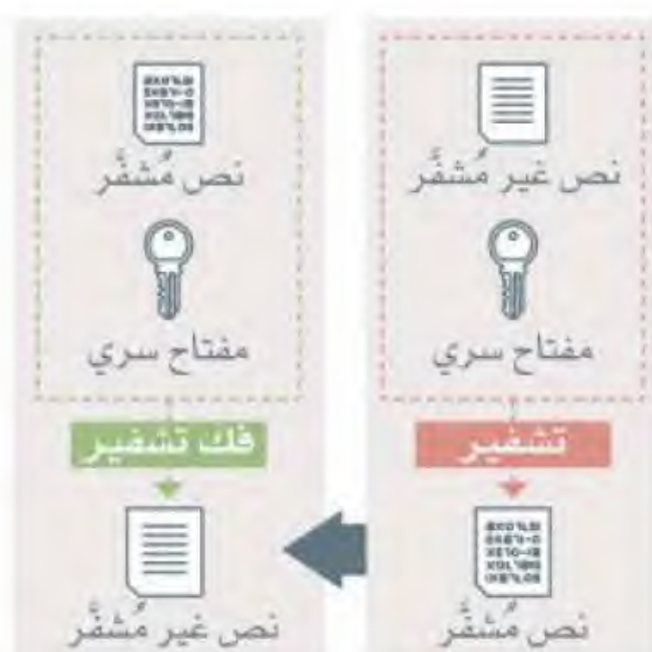
شكل 3.4: عملية التشفير باستخدام المفتاح المتماثل
