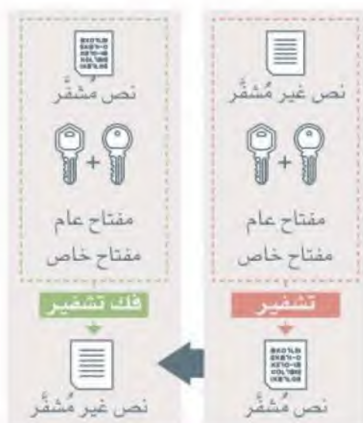
شكل 3.5: عملية التشفير باستخدام المفتاح غير المتماثل
