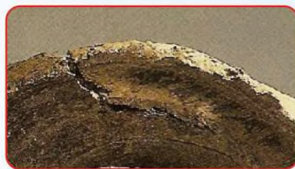
شكل ( ٥٢ ) : يوضح نتائج أخطاء التجفيف ( تشقق ).
