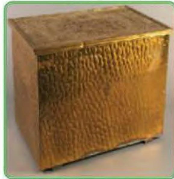
الشكل (٧٣): الطرق بالدق بالأزاميل.
