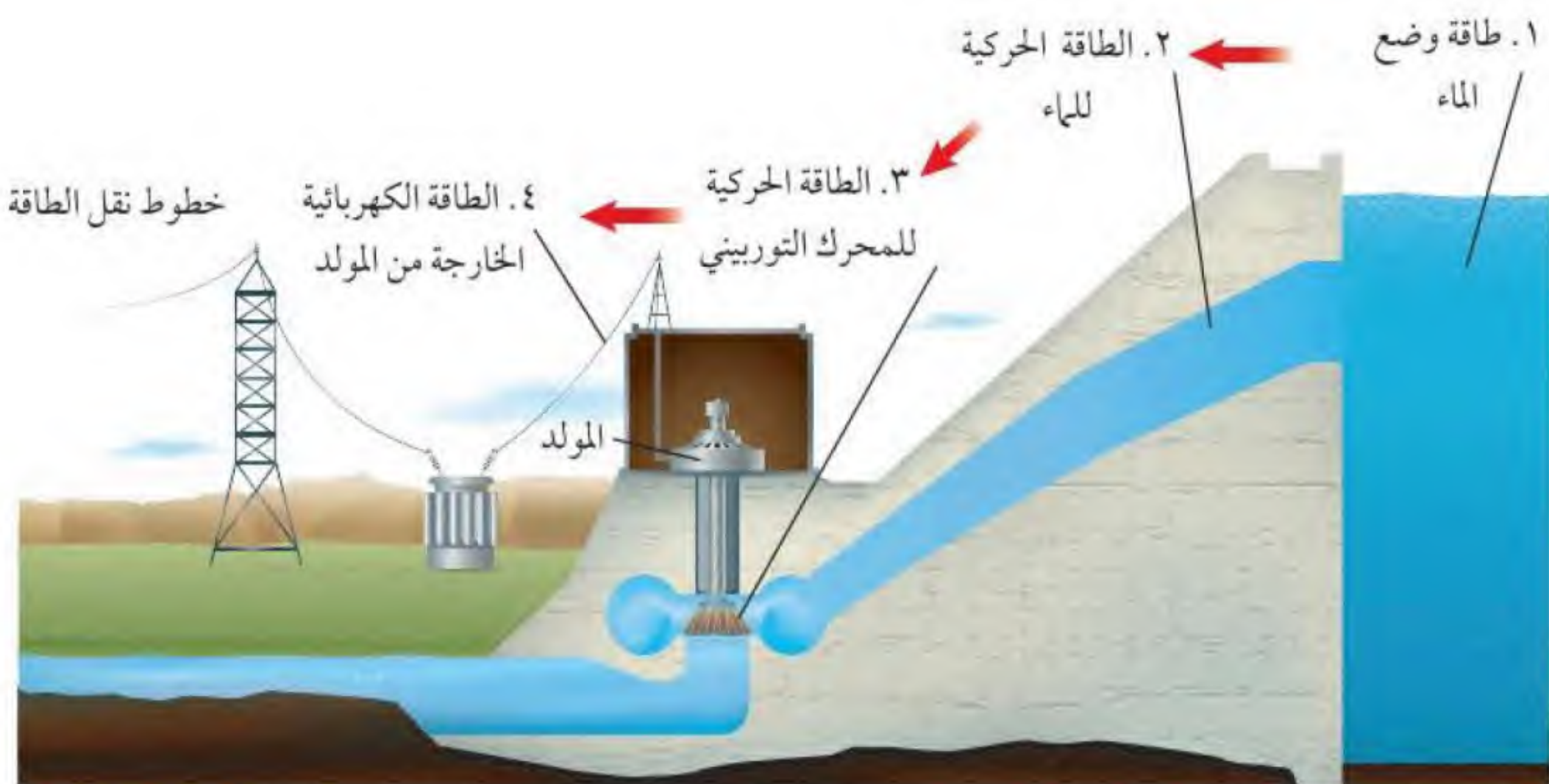
الشكل ٥ طاقة الوضع للماء خلف السد تزود التوربين بالطاقة لتشغيله. فسر. لماذا تُعد الطاقة الكهرومائية مصدرًا متجددًا للطاقة؟
