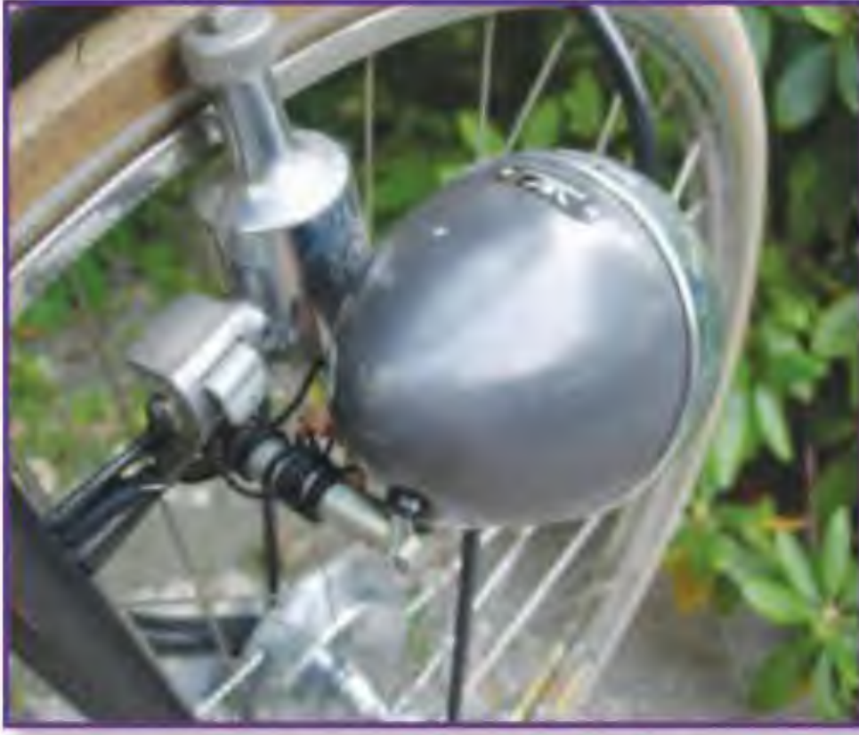
يتصل المولد الكهربائي بعجلة الدراجة
