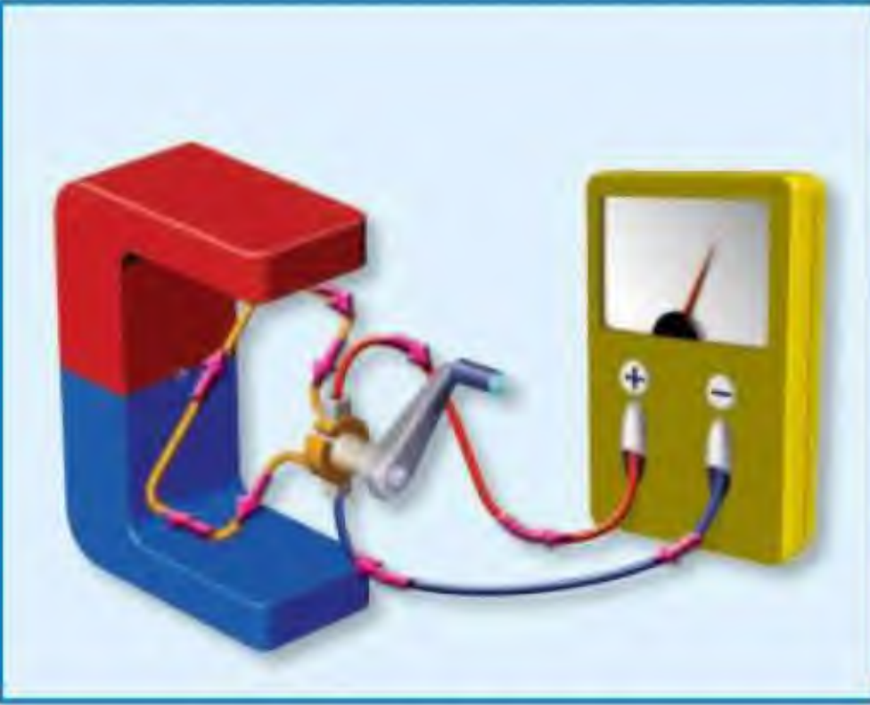
المولد الكهربائي البسيط له ملف فلزي موضوع في مجال مغناطيسي، وعندما يدور الملف يتولد تيار كهربائي.
