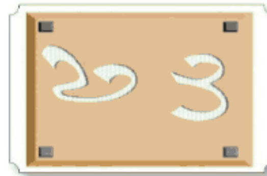
الشكل (١٣٠) تثبيت قطع مربعة من المطاط على أركان قطعة الخشب.
