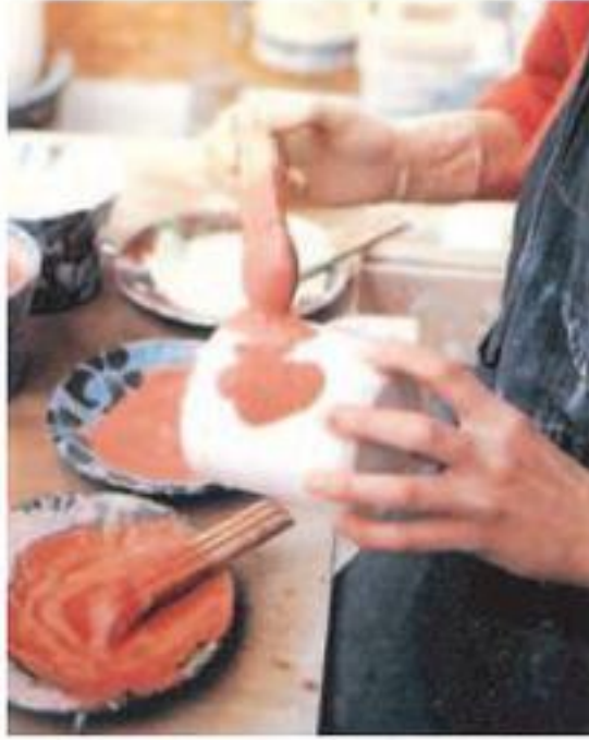
الشكل (٣٠): استخدام الفرش ذات المقاسات الكبيرة لتطبيق البطانة على كامل القطعة.
