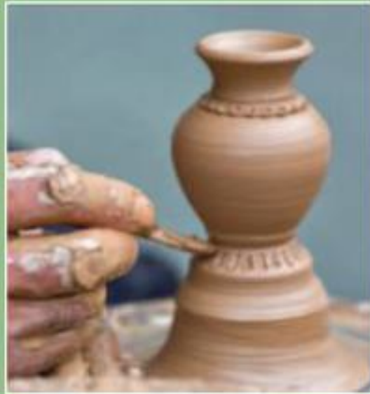
الشكل (١٦): صور توضح كيفية صنع الآنية ودوارق الماء من الطين.
