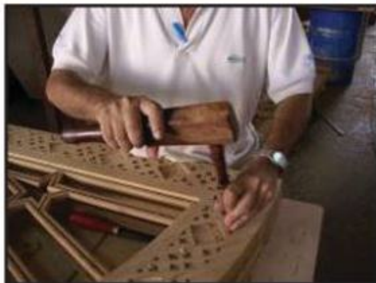
(١) : استخدام المدق الخشبي ، وهي الأداة الصحيحة .
