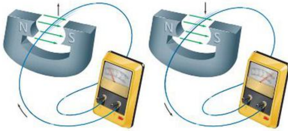
■ الشكل 1-4 عند تحريك سلك في مجال مغناطيسي يتولد فيه تيار كهربائي في أثناء حركته فقط. ويعتمد اتجاه هذا التيار على اتجاه حركة السلك داخل المجال. وتشير الأسهم إلى اتجاه التيار الاصطلاحي المتولد.
