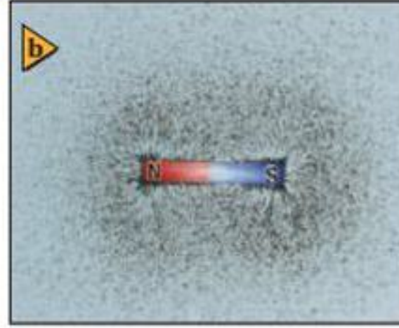
الشكل 3-4 يظهر المجال المغناطيسي لقضيب مغناطيسي بوضوح في الأبعاد الثلاثة، وذلك عند تعليق المغناطيس في الجليسرول مع برادة الحديد (a)، إلا أنه من الأسهل وضع المغناطيس أسفل ورقة، ثم رش برادة الحديد فوقها لمشاهدة نمط المجال المغناطيسي في بعدين (b).
